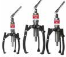
Betex HXP 2/3-Arm Abzieher, 8-50 T Kap. selbstzentrierend , mit separater Pumpe.
